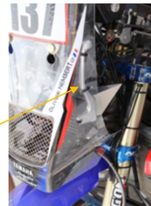
Les leviers de recharge sont installés derrière la bulle
